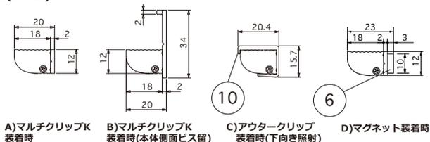
A)マルチクリップK 装着時 B)マルチクリップK 装着時(本体側面ビス留) C)アウタークリップ 装着時(下向き照射) D)マグネット装着時
