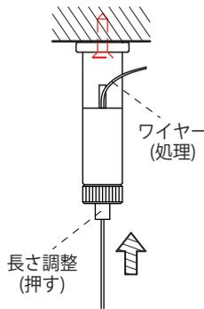
ワイヤー（灯具付き）を吊り金具に挿入し、設置高さ（両端2箇所）を調整して下さい。余ったワイヤーは切断などの処理をして下さい。
