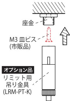
市販ビス（推奨：皿ビス M3）にて、灯具設置箇所へ吊り金具の座金（両端2箇所）を固定。吊り金具本体を回してしっかり固定。
